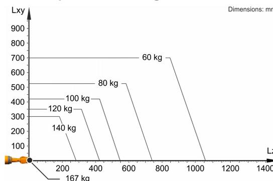
O KR 120 R2700-2 está configurado para uma capacidade de carga nominal de 120 kg, para usar de forma ideal o desempenho e a dinâmica do robô. Somente se a posição do centro de gravidade da massa for 0 mm e estiver colocada uma carga adicional otimizada para o caso de carga, é válida a capacidade de carga máxima de 167 kg. O caso de carga específico deve ser controlado com KUKA.Load ou KUKA.Compose. O Suporte KUKA está à sua disposição para maiores detalhes.
