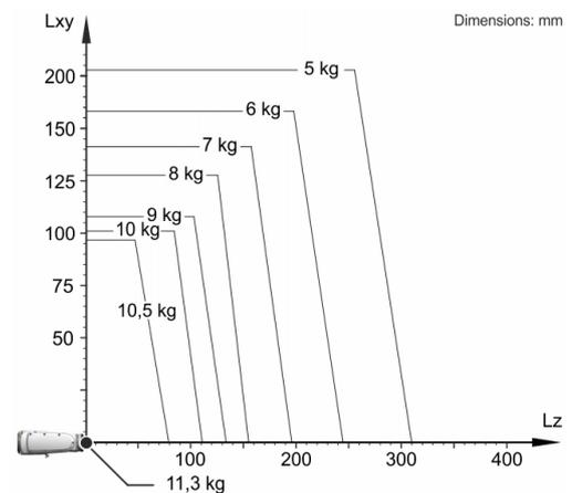
KR 10 R900-2 está configurado para una carga nominal de 10 kg para aprovechar de forma óptima el rendimiento y la dinámica del robot. Con distancias de carga reducidas y cargas adicionales favorables, puede instalarse una carga máxima de hasta 11,3 kg. La situación de carga concreta debe controlarse con KUKA Load. Para un asesoramiento individual, póngase en contacto con KUKA Service.
