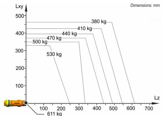
KR 500 R2830 C-F está configurado para una carga nominal de 500 kg para aprovechar de forma óptima el rendimiento y la dinámica del robot. Solo si la posición del centro de gravedad de la masa es de 0 mm y se ha aplicado una carga adicional optimizada para la situación de carga, se aplica la carga máxima de 611 kg. La situación de carga específica debe comprobarse con KUKA.Load o KUKA Compose. Para un asesoramiento individual, póngase en contacto con KUKA Support.
