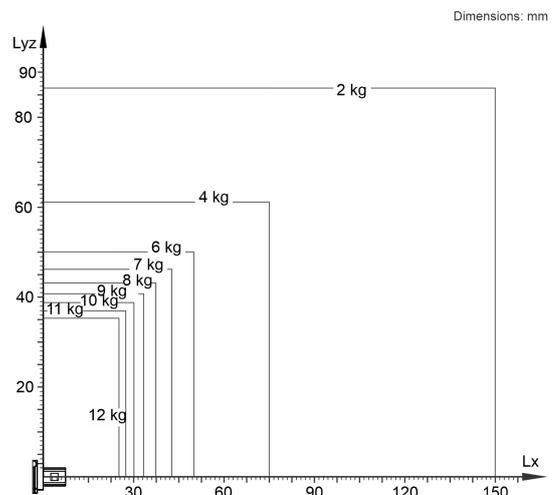
Der KR 12 R750 Z600 ist für eine Nenn-Traglast von 6 kg ausgelegt, um die Performance und Dynamik des Manipulators optimal zu nutzen. Mit reduzierten Lastabständen können auch höhere Lasten bis zur maximalen Traglast zur Anwendung kommen. Der spezifische Lastfall muss mit KUKA.Load überprüft werden. Für weitere Beratung steht der KUKA Support zur Verfügung.
