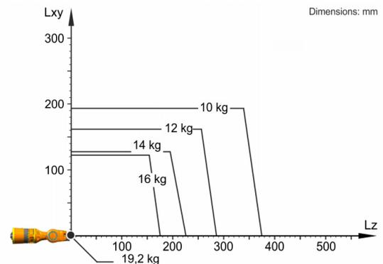
Der KR 16 R2010-2 ist ausgelegt für eine Nenn-Traglast von 16 kg, um die Performance und Dynamik des Roboters optimal zu nutzen. Nur wenn die Lage des Massenschwerpunkts 0 mm und eine für den Lastfall optimierte Zusatzlast angebracht sind, gilt die maximale Traglast von 19,2 kg. Der spezifische Lastfall muss mit KUKA.Load oder KUKA Compose überprüft werden. Für weitere Beratung steht der KUKA Support zur Verfügung.
