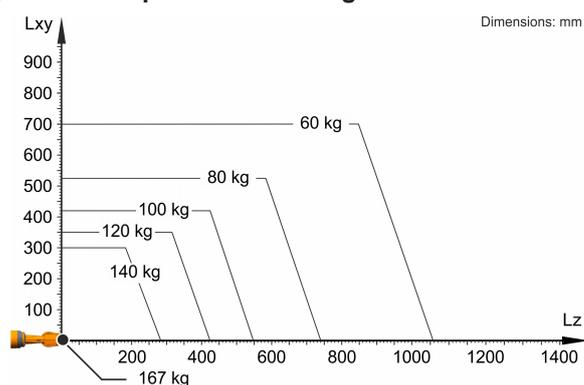
O KR 120 R2700-2 F está configurado para uma capacidade de carga nominal de 120 kg, para usar de forma ideal o desempenho e a dinâmica do robô. Somente se a posição do centro de gravidade da massa for 0 mm e estiver colocada uma carga adicional otimizada para o caso de carga, é válida a capacidade de carga máxima de 167 kg. O caso de carga específico deve ser controlado com KUKA.Load ou KUKA Compose. O Suporte KUKA está à sua disposição para maiores detalhes.
