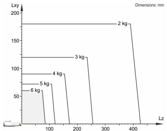
KR 6 R900 HM-SC est conçu pour une charge nominale de 3 kg pour une utilisation optimale de la performance et de la dynamique du robot. Seulement si la position du centre de gravité = 0 mm et une charge supplémentaire optimisée pour le cas de charge sont attachées, la charge maximale de 6 kg s'applique. Les cas de charge spécifiques doivent être contrôlés avec KUKA Load ou KUKA Compose. Notre assistance technique KUKA Support est à votre disposition pour vous conseiller.
