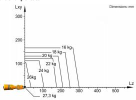
Il KR 22 R1610-2 è progettato per una portata nominale di 22 kg in grado di sfruttare al meglio le prestazioni e la dinamicità del robot. Il carico utile massimo di 27,3 kg vale solo quando sono applicati una posizione del baricentro di 0 mm e un carico aggiuntivo ottimizzato per la situazione di carico. La situazione di carico specifica deve essere verificata con KUKA.Load o KUKA Compose. Per un'ulteriore consulenza il servizio di assistenza KUKA rimane a vostra disposizione.
