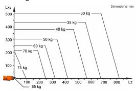
KR 70 R2100 está configurado para una carga nominal de 70 kg para aprovechar de forma óptima el rendimiento y la dinámica del robot. Con distancias de carga reducidas y cargas adicionales favorables, puede instalarse una carga máxima de hasta 85 kg. La situación de carga concreta debe controlarse con KUKA Load. Para un asesoramiento individual, póngase en contacto con KUKA Service.
