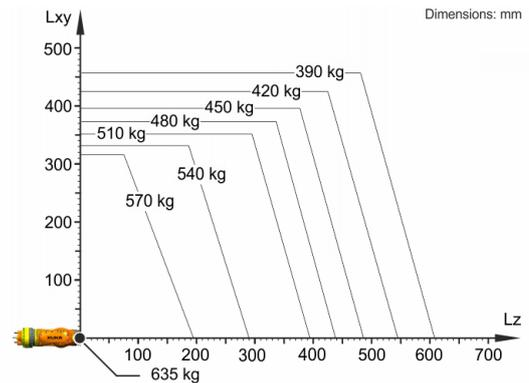
Der KR 510 R3080 F ist ausgelegt für eine Nenn-Traglast von 510 kg, um die Performance und Dynamik des Roboters optimal zu nutzen. Nur wenn die Lage des Massenschwerpunkts 0 mm und eine für den Lastfall optimierte Zusatzlast angebracht sind, gilt die maximale Traglast von 635 kg. Der spezifische Lastfall muss mit KUKA.Load oder KUKA Compose überprüft werden. Für weitere Beratung steht der KUKA Support zur Verfügung.
