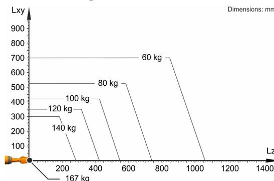
KR 120 R2700-2 est conçu pour une charge nominale de 120 kg pour une utilisation optimale de la performance et de la dynamique du robot. Seulement si la position du centre de gravité = 0 mm et une charge supplémentaire optimisée pour le cas de charge sont attachées, la charge maximale de 167 kg s'applique. Les cas de charge spécifiques doivent être contrôlés avec KUKA Load ou KUKA Compose. Notre assistance technique KUKA Support est à votre disposition pour vous conseiller.
