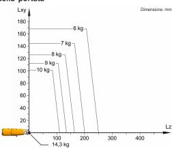
Il KR 10 R1440-2 è progettato per una portata nominale di 10 kg in grado di sfruttare al meglio le prestazioni e la dinamicità del robot. Il carico utile massimo di 14,3 kg vale solo quando sono applicati una posizione del baricentro di 0 mm e un carico aggiuntivo ottimizzato per la situazione di carico. La situazione di carico specifica deve essere verificata con KUKA.Load o KUKA Compose. Per un'ulteriore consulenza il servizio di assistenza KUKA rimane a vostra disposizione.
