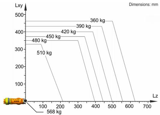
Il KR 480 R3330 MT è progettato per una portata nominale di 480 kg in grado di sfruttare al meglio le prestazioni e la dinamicità del robot. Il carico utile massimo di 568 kg vale solo quando sono applicati una posizione del baricentro di 0 mm e un carico aggiuntivo ottimizzato per la situazione di carico. La situazione di carico specifica deve essere verificata con KUKA.Load o KUKA Compose. Per un'ulteriore consulenza il servizio di assistenza KUKA rimane a vostra disposizione.
