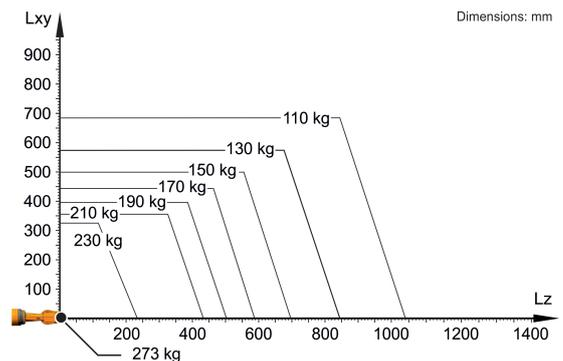
KR 210 R3300-2 K está configurado para una carga nominal de 210 kg para aprovechar de forma óptima el rendimiento y la dinámica del robot. Solo si la posición del centro de gravedad de la masa es de 0 mm y se ha aplicado una carga adicional optimizada para la situación de carga, se aplica la carga máxima de 273 kg. La situación de carga específica debe comprobarse con KUKA.Load o KUKA Compose. Para un asesoramiento individual, póngase en contacto con KUKA Support.
