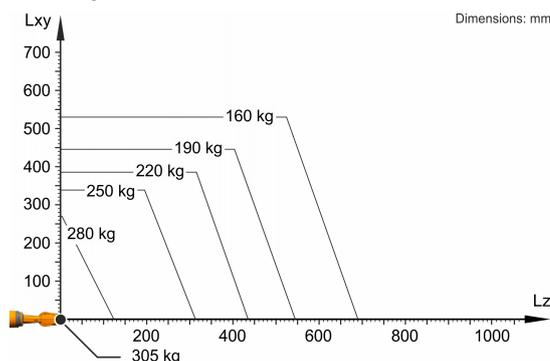
Il KR 250 R2700-2 C è progettato per una portata nominale di 250 kg in grado di sfruttare al meglio le prestazioni e la dinamicità del robot. Il carico utile massimo di 305 kg vale solo quando sono applicati una posizione del baricentro di 0 mm e un carico aggiuntivo ottimizzato per la situazione di carico. La situazione di carico specifica deve essere verificata con KUKA.Load o KUKA Compose. Per un'ulteriore consulenza il servizio di assistenza KUKA rimane a vostra disposizione.
