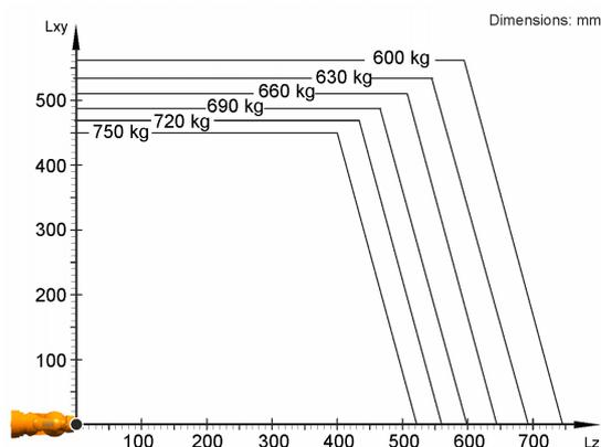
KR 1000 L750 titan F est conçu pour une charge nominale de 750 kg pour une utilisation optimale de la performance et de la dynamique du robot. Avec des distances de charge réduites et des charges supplémentaires avantageuses, il est possible d'appliquer une charge maximale allant jusqu'à 750 kg. Les cas de charge spécifiques doivent être contrôlés avec KUKA Load. Le SAV KUKA est à votre disposition pour vous conseiller.
