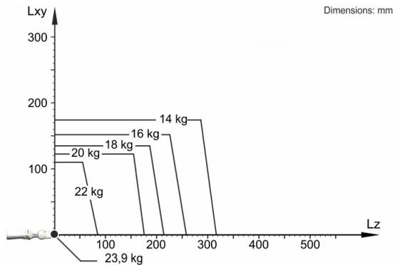
KR 20 R1810 CR está configurado para una carga nominal de 20 kg para aprovechar de forma óptima el rendimiento y la dinámica del robot. Solo si la posición del centro de gravedad de la masa es de 0 mm y se ha aplicado una carga adicional optimizada para la situación de carga, se aplica la carga máxima de 23,9 kg. La situación de carga específica debe comprobarse con KUKA.Load o KUKA Compose. Para un asesoramiento individual, póngase en contacto con KUKA Support.
