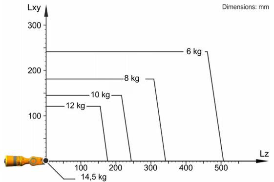
O KR 12 R1810-2 está configurado para uma capacidade de carga nominal de 12 kg, para usar de forma ideal o desempenho e a dinâmica do robô. Somente se a posição do centro de gravidade da massa for 0 mm e estiver colocada uma carga adicional otimizada para o caso de carga, é válida a capacidade de carga máxima de 14,5 kg. O caso de carga específico deve ser controlado com KUKA.Load ou KUKA.Compose. O Suporte KUKA está à sua disposição para maiores detalhes.
