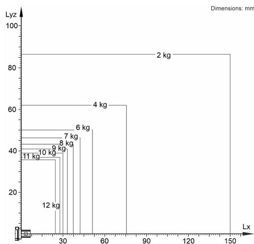
Le KR 12 R650 Z400 est conçu pour une charge nominale de 6 kg pour une utilisation optimale de la performance et de la dynamique du manipulateur. En réduisant les distances de charges, il est également possible d'utiliser des charges plus élevées jusqu'à la charge maximum. Les cas de charge spécifiques doivent être contrôlés avec KUKA.Load. Notre assistance technique KUKA Support est à votre disposition pour vous conseiller.
