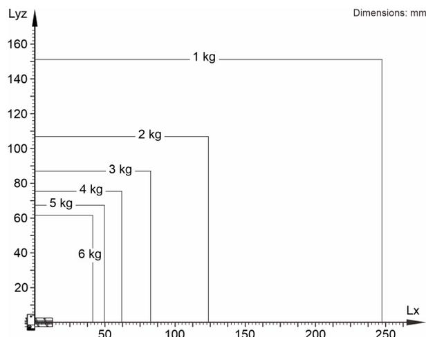
Il KR 6 R700 Z200-2 è progettato per una portata nominale di 3 kg in grado di sfruttare al meglio le prestazioni e la dinamicità del manipolatore. Con distanze di carico ridotte possono essere utilizzati anche carichi maggiori fino al carico portante massimo. La situazione di carico specifica deve essere verificata con KUKA.Load. Per un'ulteriore consulenza il servizio di assistenza KUKA rimane a vostra disposizione.
