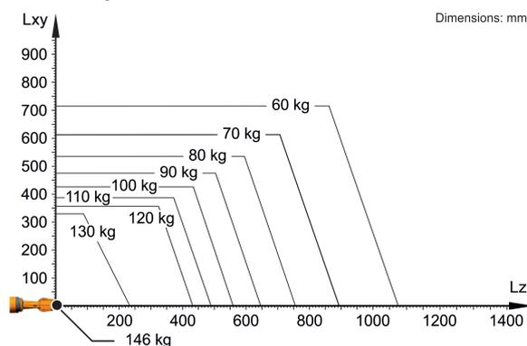
Il KR 120 R3900-2 K è progettato per una portata nominale di 120 kg in grado di sfruttare al meglio le prestazioni e la dinamicità del robot. Il carico utile massimo di 146 kg vale solo quando sono applicati una posizione del baricentro di 0 mm e un carico aggiuntivo ottimizzato per la situazione di carico. La situazione di carico specifica deve essere verificata con KUKA.Load o KUKA Compose. Per un'ulteriore consulenza il servizio di assistenza KUKA rimane a vostra disposizione.
