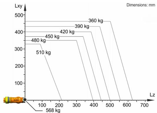
KR 480 R3330 MT está configurado para una carga nominal de 480 kg para aprovechar de forma óptima el rendimiento y la dinámica del robot. Solo si la posición del centro de gravedad de la masa es de 0 mm y se ha aplicado una carga adicional optimizada para la situación de carga, se aplica la carga máxima de 568 kg. La situación de carga específica debe comprobarse con KUKA.Load o KUKA Compose. Para un asesoramiento individual, póngase en contacto con KUKA Support.
