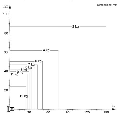
O KR 12 R850 Z340 CR está configurado para uma capacidade de carga nominal de 6 kg, para usar de forma ideal o desempenho e a dinâmica do manipulador. Com distâncias de carga reduzidas podem ser aplicadas também cargas maiores até a capacidade de carga máxima. O caso de carga específico deve ser verificado com KUKA.Load. O Suporte KUKA está à sua disposição para maiores detalhes.
