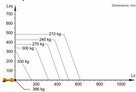
Il KR 300 R2700-2 C è progettato per una portata nominale di 300 kg in grado di sfruttare al meglio le prestazioni e la dinamicità del robot. Il carico utile massimo di 366 kg vale solo quando sono applicati una posizione del baricentro di 0 mm e un carico aggiuntivo ottimizzato per la situazione di carico. La situazione di carico specifica deve essere verificata con KUKA.Load o KUKA Compose. Per un'ulteriore consulenza il servizio di assistenza KUKA rimane a vostra disposizione.
