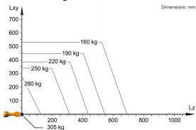
KR 250 R2700-2 C est conçu pour une charge nominale de 250 kg pour une utilisation optimale de la performance et de la dynamique du robot. Seulement si la position du centre de gravité = 0 mm et une charge supplémentaire optimisée pour le cas de charge sont attachées, la charge maximale de 305 kg s'applique. Les cas de charge spécifiques doivent être contrôlés avec KUKA Load ou KUKA Compose. Notre assistance technique KUKA Support est à votre disposition pour vous conseiller.
