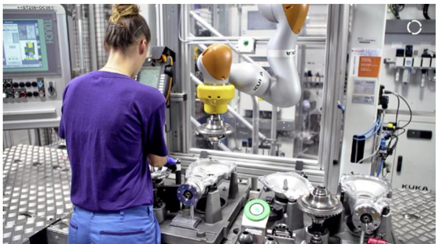
Bild 3. Werkerin und Roboter montieren gemeinsam ein Hinterachsgetriebe [2] (Quelle: KUKA Systems GmbH ©)
