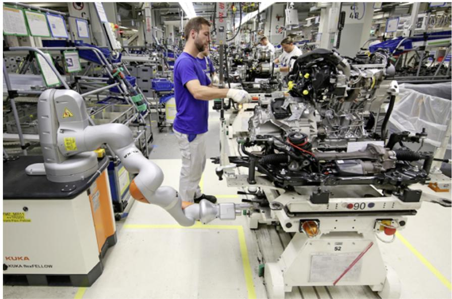
Bild 2. Anlage zur Verschraubung der Pendelstütze (Quelle: Volkswagen AG ©)
