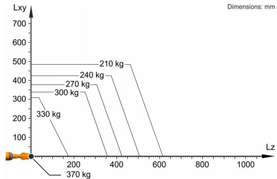
Der KR 300 R2700-2 ist ausgelegt für eine Nenn-Traglast von 300 kg, um die Performance und Dynamik des Roboters optimal zu nutzen. Nur wenn die Lage des Massenschwerpunkts 0 mm und eine für den Lastfall optimierte Zusatzlast angebracht sind, gilt die maximale Traglast von 370 kg. Der spezifische Lastfall muss mit KUKA.Load oder KUKA Compose überprüft werden. Für weitere Beratung steht der KUKA Support zur Verfügung.
