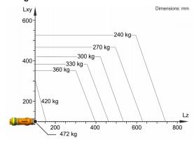
Der KR 360 R2830 ist ausgelegt für eine Nenn-Traglast von 360 kg, um die Performance und Dynamik des Roboters optimal zu nutzen. Nur wenn die Lage des Massenschwerpunkts 0 mm und eine für den Lastfall optimierte Zusatzlast angebracht sind, gilt die maximale Traglast von 472 kg. Der spezifische Lastfall muss mit KUKA.Load oder KUKA Compose überprüft werden. Für weitere Beratung steht der KUKA Support zur Verfügung.
