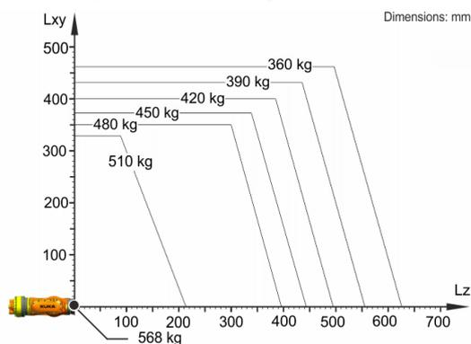
O KR 480 R3330 MT está configurado para uma capacidade de carga nominal de 480 kg, para usar de forma ideal o desempenho e a dinâmica do robô. Somente se a posição do centro de gravidade da massa for 0 mm e estiver colocada uma carga adicional otimizada para o caso de carga, é válida a capacidade de carga máxima de 568 kg. O caso de carga específico deve ser controlado com KUKA.Load ou KUKA Compose. O Suporte KUKA está à sua disposição para maiores detalhes.
