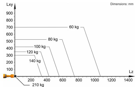
KR 120 R3100-2 está configurado para una carga nominal de 120 kg para aprovechar de forma óptima el rendimiento y la dinámica del robot. Solo si la posición del centro de gravedad de la masa es de 0 mm y se ha aplicado una carga adicional optimizada para la situación de carga, se aplica la carga máxima de 210 kg. La situación de carga específica debe comprobarse con KUKA.Load o KUKA Compose. Para un asesoramiento individual, póngase en contacto con KUKA Support.
