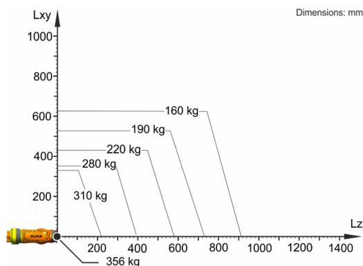
O KR 280 R3080 está configurado para uma capacidade de carga nominal de 280 kg, para usar de forma ideal o desempenho e a dinâmica do robô. Somente se a posição do centro de gravidade da massa for 0 mm e estiver colocada uma carga adicional otimizada para o caso de carga, é válida a capacidade de carga máxima de 356 kg. O caso de carga específico deve ser controlado com KUKA.Load ou KUKA Compose. O Suporte KUKA está à sua disposição para maiores detalhes.
