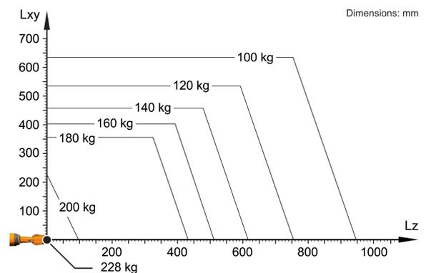
Der KR 180 R3500-2 K ist ausgelegt für eine Nenn-Traglast von 180 kg, um die Performance und Dynamik des Roboters optimal zu nutzen. Nur wenn die Lage des Massenschwerpunkts 0 mm und eine für den Lastfall optimierte Zusatzlast angebracht sind, gilt die maximale Traglast von 228 kg. Der spezifische Lastfall muss mit KUKA.Load oder KUKA Compose überprüft werden. Für weitere Beratung steht der KUKA Support zur Verfügung.
