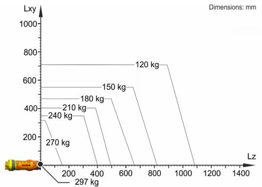
KR 240 R3330 C は、ロボットの性能とダイナミクスを最適に使用するため、240 kg の公称可搬重量用に設計されています。質量の重心が 0 mm であり、荷重のケースに対して最適化された追加荷重がかけられている場合に限り、最大の可搬重量が適用されます 297 kg。特定の荷重のケースでは、KUKA.Load または KUKA Compose を用いた確認が必要です。その他のアドバイスに関しては、KUKA サポートにお気軽にお尋ねください。
