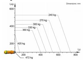
Der KR 360 R2830 F ist ausgelegt für eine Nenn-Traglast von 360 kg, um die Performance und Dynamik des Roboters optimal zu nutzen. Nur wenn die Lage des Massenschwerpunkts 0 mm und eine für den Lastfall optimierte Zusatzlast angebracht sind, gilt die maximale Traglast von 472 kg. Der spezifische Lastfall muss mit KUKA.Load oder KUKA Compose überprüft werden. Für weitere Beratung steht der KUKA Support zur Verfügung.
