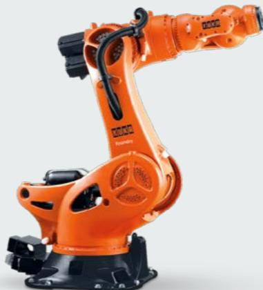
Die KR 1000 titan F Serie mit einer Traglast von bis zu 1.300 kg und einer großen Reichweite ermöglicht präzises Handhaben von Bauteilen im XL-Format, wie z. B. großen Motorblöcken.
