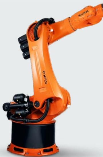
KR FORTEC ist die perfekte Wahl beim Handling schwerer Bauteile. Mit einzigartiger Modellvielfalt für Traglasten bis 600 Kilogramm.
