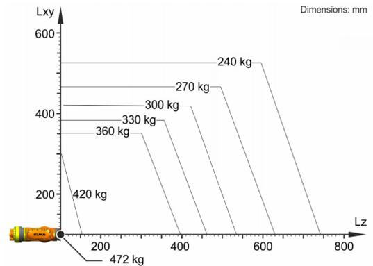
KR 360 R2830 está configurado para una carga nominal de 360 kg para aprovechar de forma óptima el rendimiento y la dinámica del robot. Solo si la posición del centro de gravedad de la masa es de 0 mm y se ha aplicado una carga adicional optimizada para la situación de carga, se aplica la carga máxima de 472 kg. La situación de carga específica debe comprobarse con KUKA.Load o KUKA Compose. Para un asesoramiento individual, póngase en contacto con KUKA Support.
