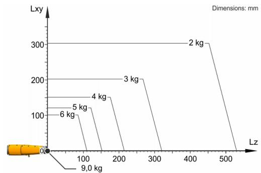
KR 6 R1840-2 está configurado para una carga nominal de 6 kg para aprovechar de forma óptima el rendimiento y la dinámica del robot. Solo si la posición del centro de gravedad de la masa es de 0 mm y se ha aplicado una carga adicional optimizada para la situación de carga, se aplica la carga máxima de 9 kg. La situación de carga específica debe comprobarse con KUKA.Load o KUKA Compose. Para un asesoramiento individual, póngase en contacto con KUKA Support.
