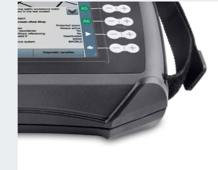
**Integrierte Protektoren.** Damit ist das KUKA smartPAD bei einem Sturz maximal geschützt. Das kratzfeste Display sowie die Schutzklasse IP54 erlauben den Einsatz im rauen industriellen Umfeld.
