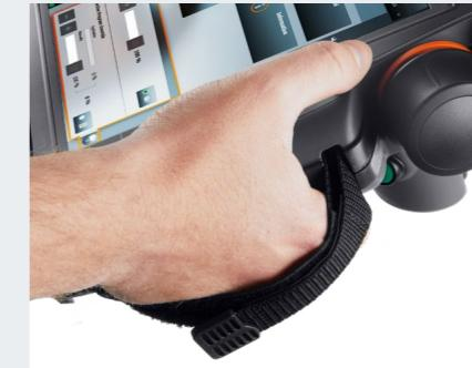
**Bequemes, entspanntes Handling.** Das KUKA smartPAD begeistert mit seiner angenehmen Handhabung. Halteschlaufen und Haltegriffe, die beidhändig genutzt werden können, erleichtern die Bedienung um ein Vielfaches. Optional ermöglicht ein Schultergurt ein ermüdfreies Arbeiten – vor allem während zeitintensiver Projekte.
