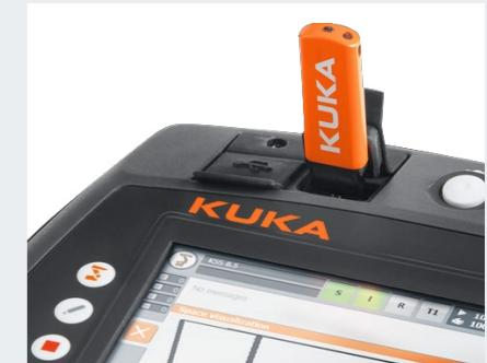
**Hardware state of the art.** Dank neuester Hardware überzeugt das KUKA smartPAD mit starker Performance. Zwei leicht zugängliche USB-Anschlüsse ermöglichen ein direktes Speichern und Einlesen von Anwenderprogrammen sowie den Anschluss von weiteren unterstützten USB-Geräten.
