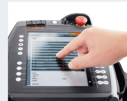
**Zielsichere Bedienung durch brillantes, kapazitives Touch-Display.** Die Eingaben erfolgen schnell und einfach über den 8,4 Zoll großen Bildschirm.
