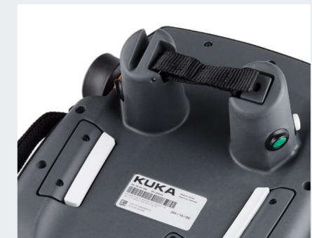
**Elemente für ergonomische Links- und Rechtshänder-Bedienung.** Die Serviceklappe für den einfachen Kabeltausch komplettiert die Benutzerfreundlichkeit des KUKA smartPAD.
