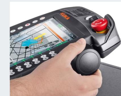
**Einfaches Roboterverfahren mit der ergonomischen 6D-Maus.** Sie bietet ein intuitives Verfahren sowie Umorientieren des Roboters in drei oder sechs Freiheitsgraden.
