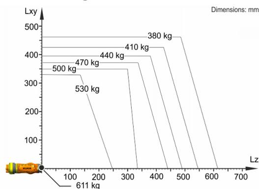
KR 500 R2830 C est conçu pour une charge nominale de 500 kg pour une utilisation optimale de la performance et de la dynamique du robot. Seulement si la position du centre de gravité = 0 mm et une charge supplémentaire optimisée pour le cas de charge sont attachées, la charge maximale de 611 kg s'applique. Les cas de charge spécifiques doivent être contrôlés avec KUKA Load ou KUKA Compose. Notre assistance technique KUKA Support est à votre disposition pour vous conseiller.
