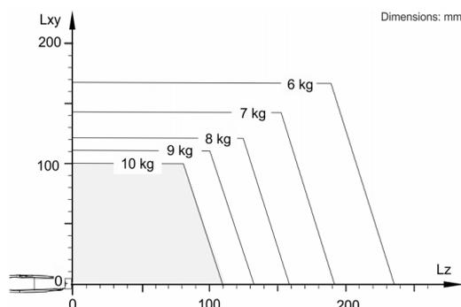
O KR 10 R1420 está configurado para uma capacidade de carga nominal de 10 kg para usar de forma ideal o desempenho e a dinâmica do robô. Com distâncias de carga reduzidas podem ser aplicadas também cargas maiores até a capacidade de carga máxima. O caso de carga específico deve ser verificado com KUKA.Load. O Suporte KUKA está à sua disposição para maiores detalhes.
