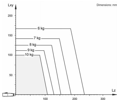
Il KR 10 R1100 CR è progettato per una portata nominale di 5 kg in grado di sfruttare al meglio le prestazioni e la dinamicità del robot. Il carico utile massimo di 10 kg vale solo quando sono applicati una posizione del baricentro di 0 mm e un carico aggiuntivo ottimizzato per la situazione di carico. La situazione di carico specifica deve essere verificata con KUKA.Load o KUKA Compose. Per un'ulteriore consulenza il servizio di assistenza KUKA rimane a vostra disposizione.
