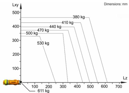
Der KR 500 R2830 MT-F ist ausgelegt für eine Nenn-Traglast von 500 kg, um die Performance und Dynamik des Roboters optimal zu nutzen. Nur wenn die Lage des Massenschwerpunkts 0 mm und eine für den Lastfall optimierte Zusatzlast angebracht sind, gilt die maximale Traglast von 611 kg. Der spezifische Lastfall muss mit KUKA.Load oder KUKA Compose überprüft werden. Für weitere Beratung steht der KUKA Support zur Verfügung.
