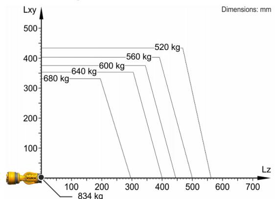
KR 640 R2800-2 está configurado para una carga nominal de 640 kg para aprovechar de forma óptima el rendimiento y la dinámica del robot. Con distancias de carga reducidas y cargas adicionales favorables, puede instalarse una carga máxima de hasta 834 kg. La situación de carga concreta debe controlarse con KUKA Load. Para un asesoramiento individual, póngase en contacto con KUKA Service.
