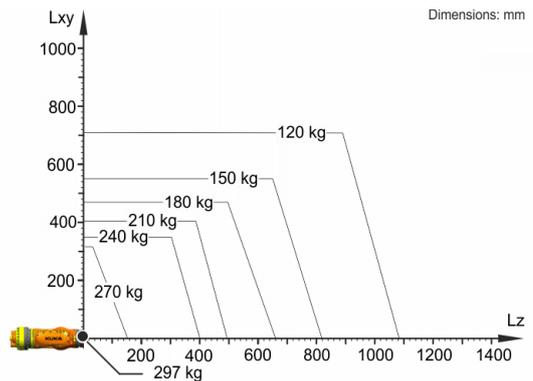
KR 240 R3330 C está configurado para una carga nominal de 240 kg para aprovechar de forma óptima el rendimiento y la dinámica del robot. Solo si la posición del centro de gravedad de la masa es de 0 mm y se ha aplicado una carga adicional optimizada para la situación de carga, se aplica la carga máxima de 297 kg. La situación de carga específica debe comprobarse con KUKA.Load o KUKA Compose. Para un asesoramiento individual, póngase en contacto con KUKA Support.
