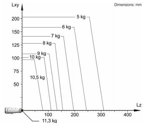
O KR 10 R900-2 está configurado para uma capacidade de carga nominal de 10 kg, para usar de forma ideal o desempenho e a dinâmica do robô. Com distâncias de carga reduzidas e cargas adicionais favoráveis, pode ser instalada uma capacidade de carga máxima de até 11,3 kg. O caso de carga específico deve ser verificado com KUKA Load. O KUKA Service está à sua disposição para mais consultoria.
