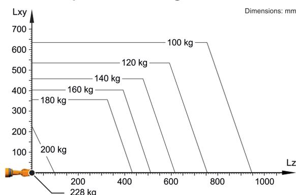
O KR 180 R3500-2 K está configurado para uma capacidade de carga nominal de 180 kg, para usar de forma ideal o desempenho e a dinâmica do robô. Somente se a posição do centro de gravidade da massa for 0 mm e estiver colocada uma carga adicional otimizada para o caso de carga, é válida a capacidade de carga máxima de 228 kg. O caso de carga específico deve ser controlado com KUKA.Load ou KUKA Compose. O Suporte KUKA está à sua disposição para maiores detalhes.
