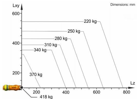
KR 340 R3330 est conçu pour une charge nominale de 340 kg pour une utilisation optimale de la performance et de la dynamique du robot. Seulement si la position du centre de gravité = 0 mm et une charge supplémentaire optimisée pour le cas de charge sont attachées, la charge maximale de 418 kg s'applique. Les cas de charge spécifiques doivent être contrôlés avec KUKA Load ou KUKA Compose. Notre assistance technique KUKA Support est à votre disposition pour vous conseiller.
