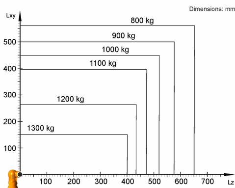
Il KR 1000 1300 titan PA-F è progettato per una portata nominale di 1300 kg in grado di sfruttare al meglio le prestazioni e la dinamicità del robot. Con distanze di carico ridotte e carichi addizionali favorevoli è possibile applicare un carico utile massimo di 1300 kg. La situazione di carico specifica deve essere verificata con KUKA Load. Per un'ulteriore consulenza il servizio di assistenza KUKA rimane a vostra disposizione.
