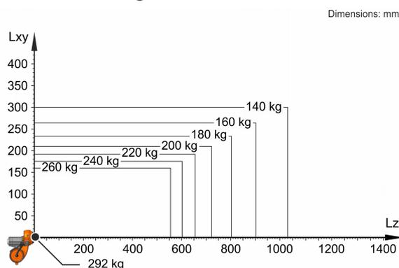
KR 240 R3200-2 PA est conçu pour une charge nominale de 240 kg pour une utilisation optimale de la performance et de la dynamique du robot. Avec des distances de charge réduites et des charges supplémentaires avantageuses, il est possible d'appliquer une charge maximale allant jusqu'à 292 kg. Les cas de charge spécifiques doivent être contrôlés avec KUKA Load. Le SAV KUKA est à votre disposition pour vous conseiller.
