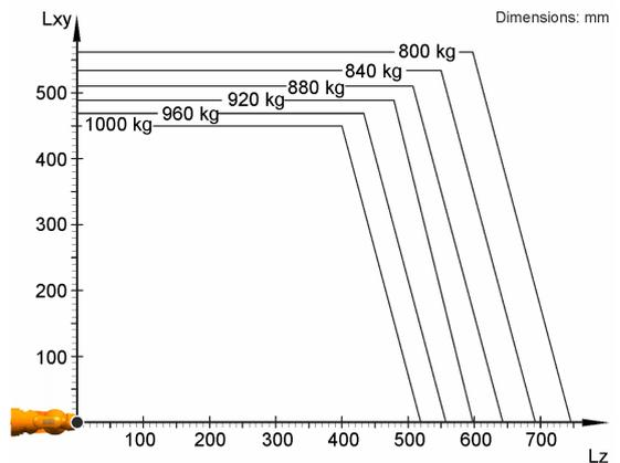
Der KR 1000 titan F ist ausgelegt für eine Nenn-Traglast von 1000 kg, um die Performance und Dynamik des Roboters optimal zu nutzen. Mit reduzierten Lastabständen und günstigen Zusatzlasten, kann eine maximale Traglast bis zu 1000 kg angebracht werden. Der spezifische Lastfall muss mit KUKA Load überprüft werden. Für weitere Beratung steht der KUKA Service zur Verfügung.
